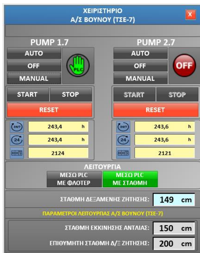
Εικόνα 19: Παράθυρο χειρισμών-παραμετροποίησης αντλίας PUMP1.7
