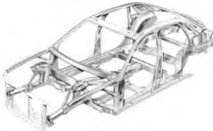
Σχήμα 1-3: Δομές διαστημικού πλαισίου. Πηγή: Audi AG [1] .
