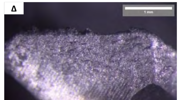
Σχήμα 4-16: Τυπική φθορά στις κύριες κόψεις για v_c = 24 \text{ m/min} και f = 0,2 \text{ mm/rev} . Α) N = 10 οπές της 1 ης κοπτικής ακμής, Β) N = 20 οπές της 1 ης κοπτικής ακμής, Γ) N = 10 οπές της 2 ης κοπτικής ακμής, Δ) N = 20 οπές της 2 ης κοπτικής ακμής.
