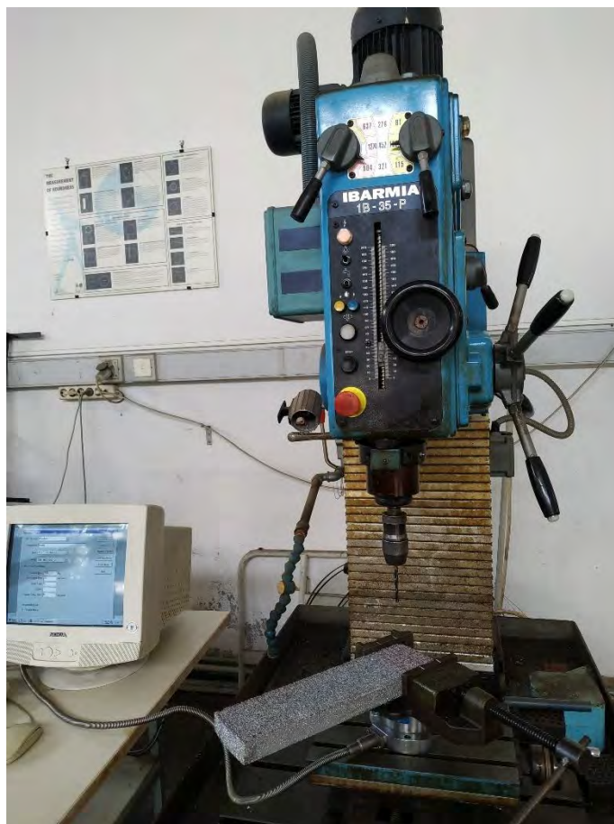
Σχήμα 3-1: Πειραματική Διάταξη όπου φαίνονται το δράπανο, ο σφικτήρας, το τεμάχιο, το δυναμόμετρο και η οθόνη του υπολογιστή.
