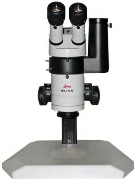
Σχήμα 3-7: Μικροσκόπιο Leica τύπου Wild M3Z StereoZoom.
