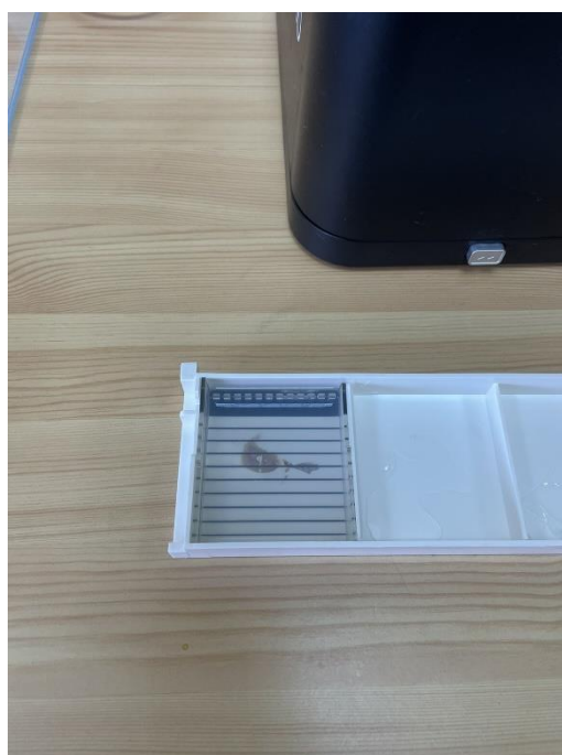
Εικόνα 9. Gel Αγαρόζης, το οποίο πρόκειται να τοποθετηθεί στη συσκευή Ηλεκτροφόρησης. Απαντάται μέσα στο καλούπι και διακρίνονται τα πηγαδάκια.
