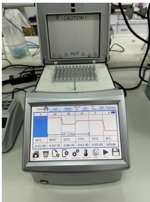
Εικόνα 7. Θερμοκυκλοποιητής PCR Fast Gene, του οποίου οι συνθήκες έχουν ρυθμιστεί για την διεξαγωγή PCR με τον εκκινητή ITS2.
