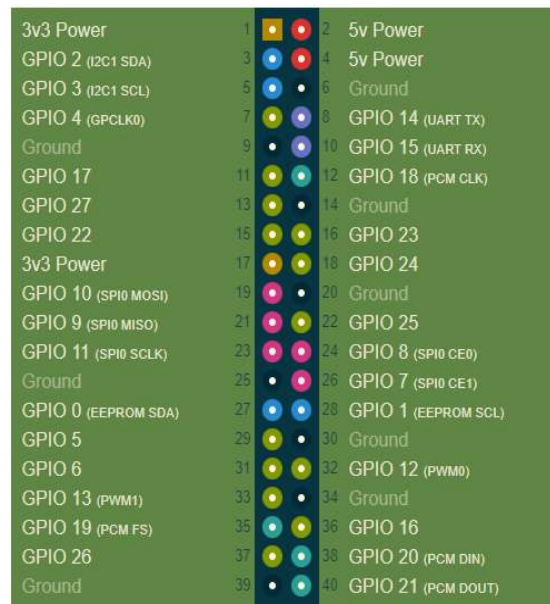
Σχήμα 2.5: Διάγραμμα GPIO pins (Pinout, 2023)
