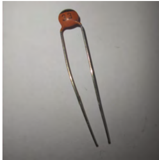
Σχήμα 5.4: Κεραμικός πυκνωτής 33pF .
