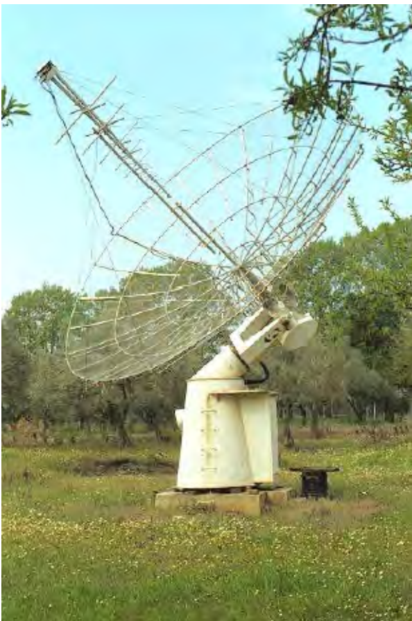
Σχήμα 1.13: Η κεραία του ηλιακού ραδιοφασματογράφου ( ARTEMIS-IV ) στις Θερμοπύλες, με κάτοπτρο από μεταλλικό πλέγμα [6].
