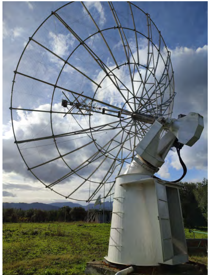
Σχήμα 1.13: Η κεραία του ηλιακού ραδιοφασματογράφου ( ARTEMIS-IV ) στις Θερμοπύλες, με κάτοπτρο από μεταλλικό πλέγμα [6].
