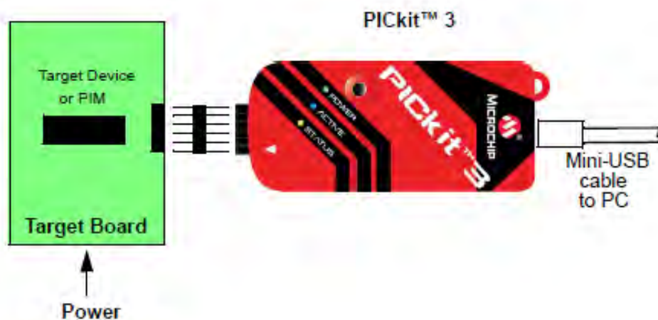
Σχήμα 3.4: Το κύκλωμα διασύνδεσης του μικροελεγκτή με τον υπολογιστή μας, ( In-circuit programmer-debugger ) PICKit™ 3 [16].
