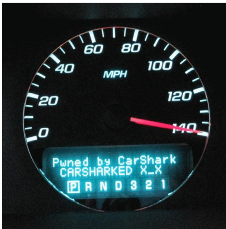
Εικόνα 31: Εμφάνιση αυθαίρετου μηνύματος και ψευδής ανάγνωση της ταχύτητας [8]
