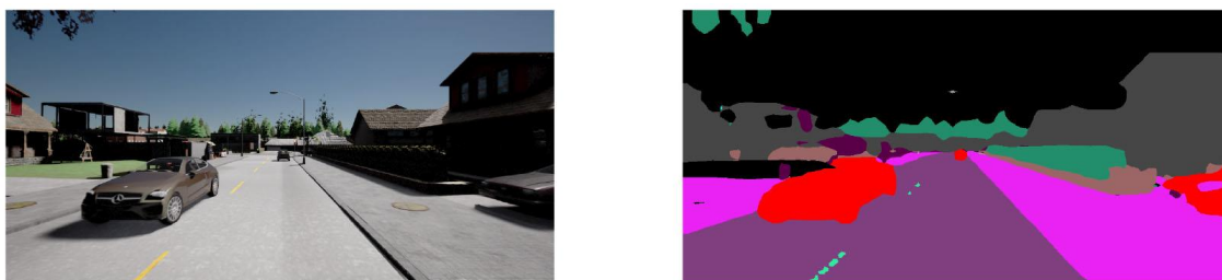
Εικόνα 36: Αρχική εικόνα και τμηματοποίηση της με την χρήση του Deeplabv3 [10]
