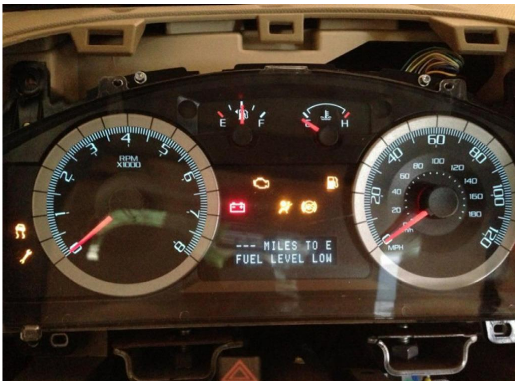
Εικόνα 32: Απεικόνιση οργάνων οχήματος και λανθασμένη ένδειξη χαμηλής στάθμης βενζίνης [8]
