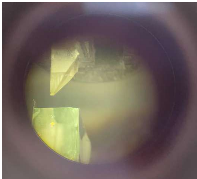
Εικόνα 4: Φωτογραφία μέσα από το φακό του υπερμικροτόμου. Διακρίνονται κάτω αριστερά η «βάρκα» με τις χρυσές τομές στην επιφάνεια του νερού και πάνω αριστερά το μπλοκάκι με τον ιστό στην κορυφή του.
