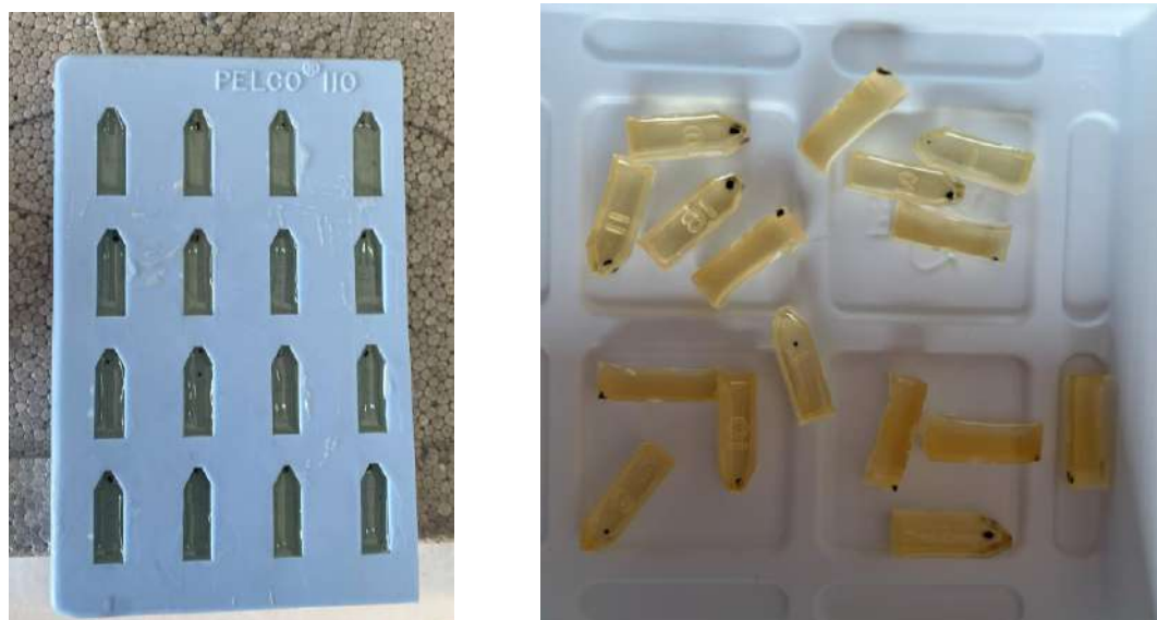
Εικόνα 3: Η ειδική αριθμημένη θήκη για εγκλεισμό των δειγμάτων με ρητίνη (αριστερά). Τα μπλοκάκια ρητίνης με τον ιστό να διακρίνεται με σκούρο χρώμα στην κορυφή τους (δεξιά).
