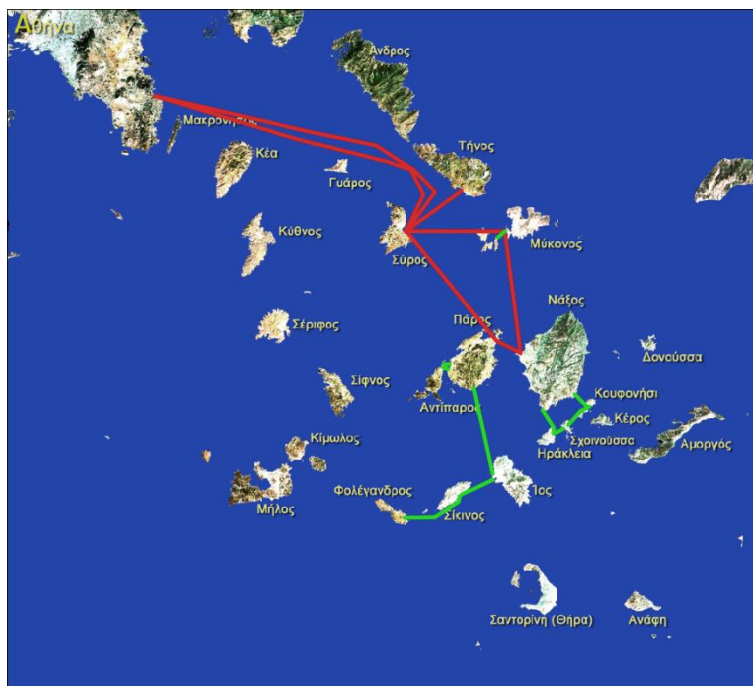
Σχήμα 35: Διασυνδεδεμένα νησιά με τον ΥΣ της Σύρου μέσω του δικτύου του ΑΔΜΗΕ και του ΔΕΔΔΗΕ (προσωπική επεξεργασία)
