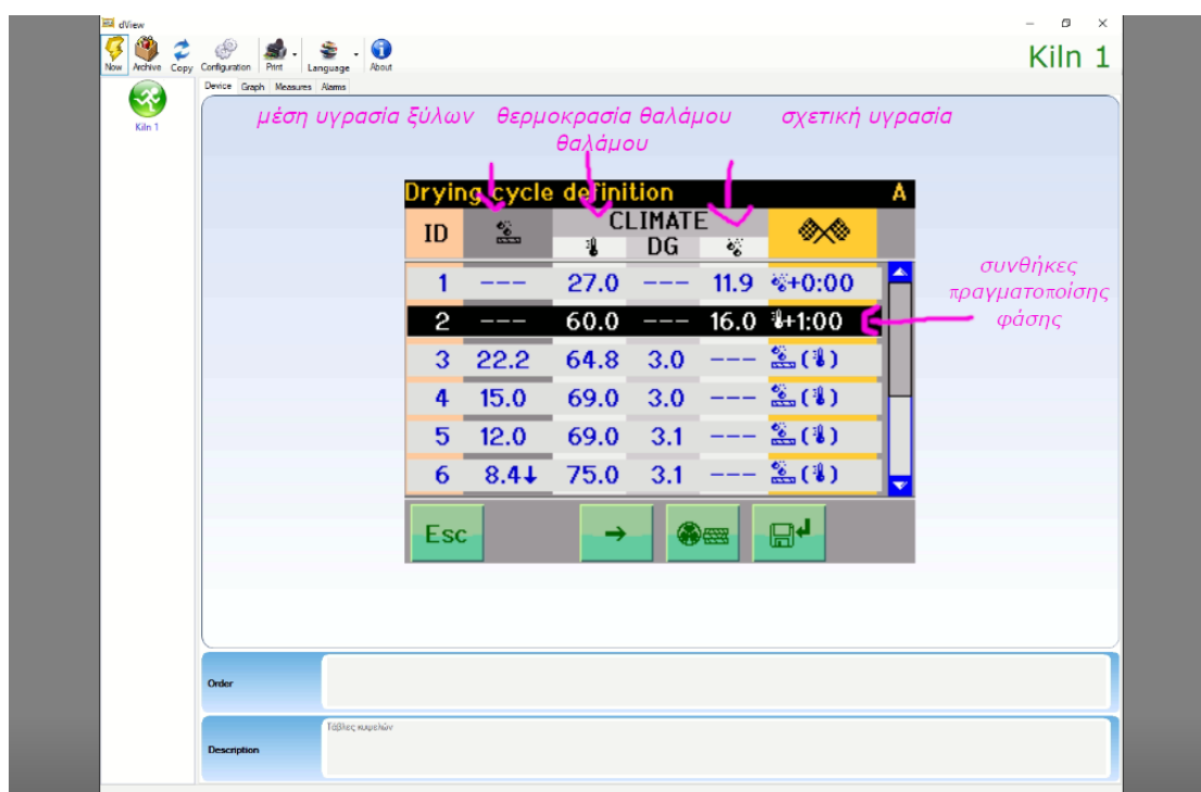
Εικόνα 14, 15 & 16 Περιβάλλον προγράμματος ξήρανσης της εταιρείας Logica HS σε οθόνης H/Y, όπου ο χρήστης αρχικά ρυθμίζει τις παραμέτρους και στη συνέχεια παρακολουθεί την πορεία του προγράμματος ξήρανσης
