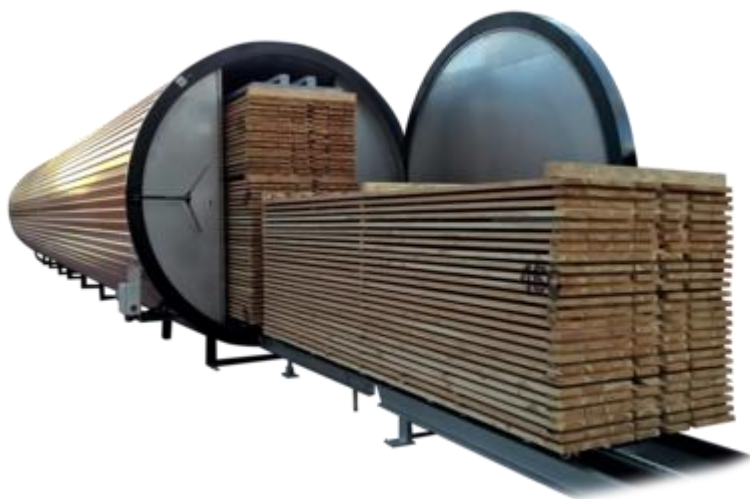
Εικόνα 17: Ξηραντήριο με θάλαμο κενού και βαγόνι φόρτωσης
