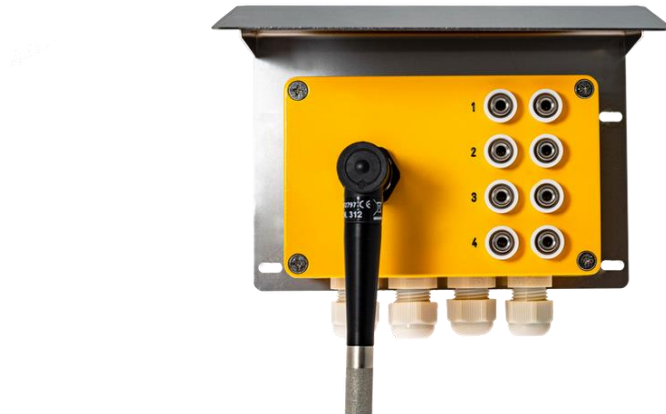
Εικόνα 13: Σύστημα μέτρησης υγρασίας και θερμοκρασίας μέσα στον θάλαμο της Ιταλικής εταιρείας Logica HS. Στο συγκεκριμένο σύστημα συνδέονται τα καλώδια που τοποθετούνται στα ξύλα.
