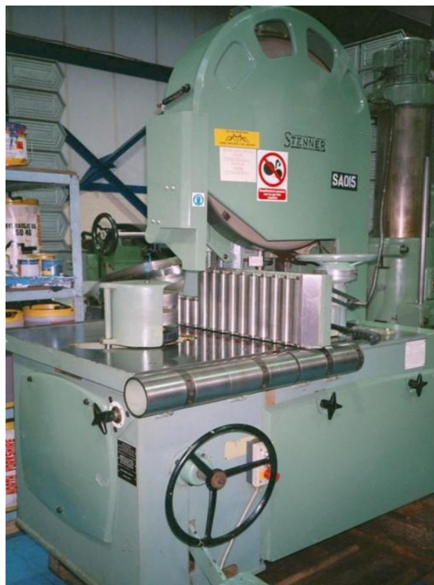
Εικόνα 7: Μηχάνημα (ταινιοπρίονας) επανάπρισης, της εταιρείας Stenner.
