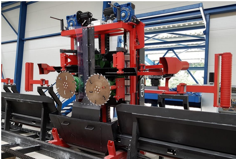
Εικόνα 4: Σύγχρονο δισκοπρίονο με 2 δίσκους της εταιρείας StorjCad, σλοβάκινης προέλευσης.
