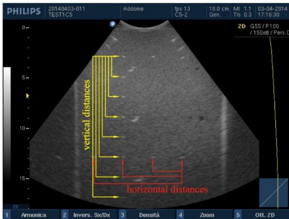
Εικόνα 14: Έλεγχος ακρίβειας στις μετρούμενες αποστάσεις. (Ανατύπωση από: Scorza et al., 2015)
