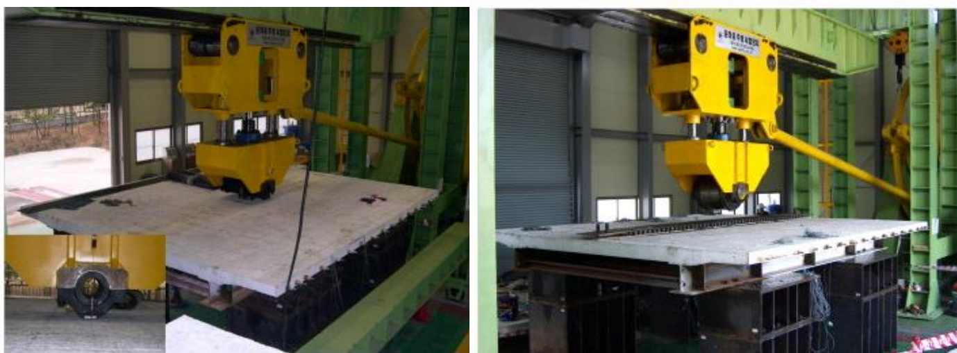
Σχήμα 5.31: Στατική δοκιμή και δοκιμή υπό φορτίο τροχού, Hwang et al. (2010)
