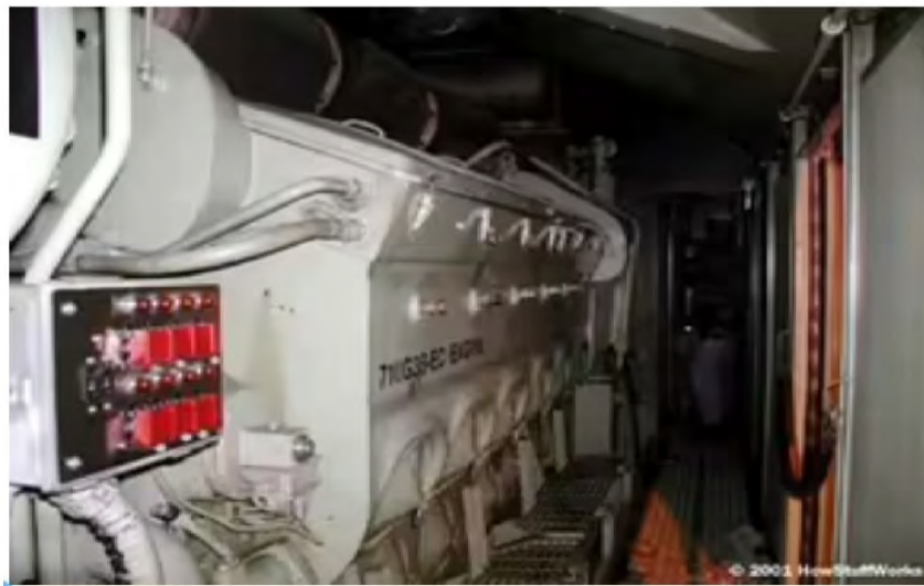
Εικόνα 2.2.6 Δίχρονη, δωδεκα-κύλινδρη μηχανή ισχύος 3200 ίππων στις 904 RPM (Homer, 2001)
