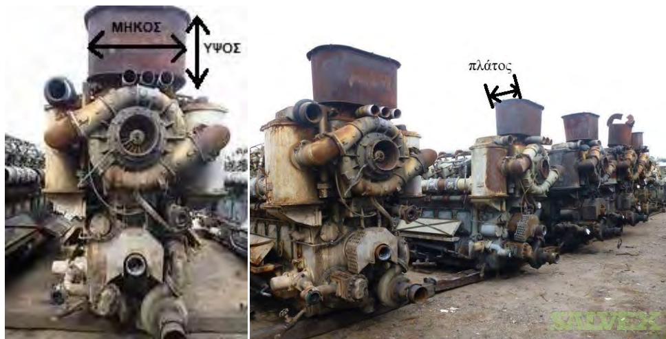
Εικόνα 7.1.5. Διαστάσεις εξάτμισης κινητήρα GE 7FDL16
