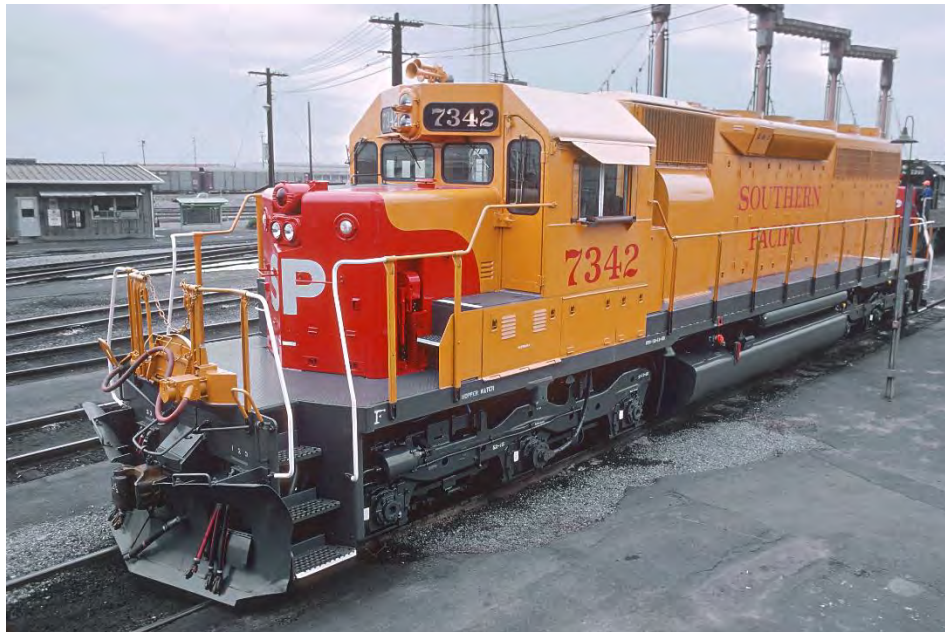
Εικόνα 2.2.6 (Bernard, 1980)Ντίζελο-ηλεκτρική σιδηροδρομική μηχανή της General Motors“SD40”ισχύος 3000 ίππων στις 900 RPM (Bachand, 2006)
