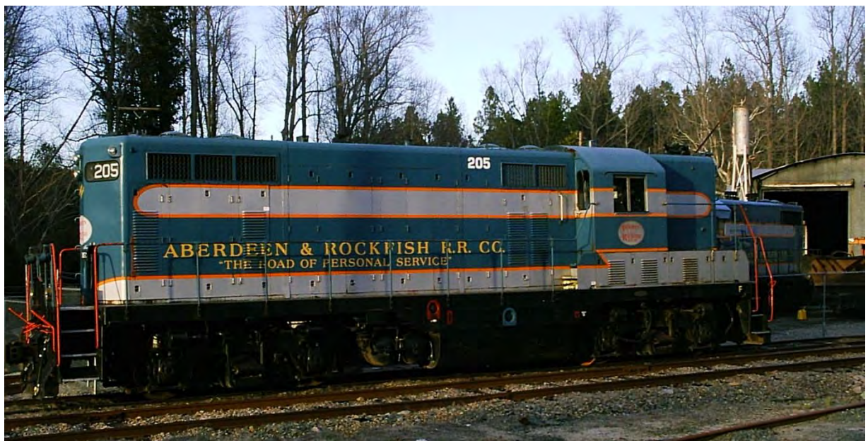
Εικόνα 1.2.1 (Marlin, 2008) Η νηξελο-ηλεκτρική μηχανή της General Motors GP7 ισχύος 1500 ίππων (1119 kW) στις 800 RPM (Bachand, 2006)
