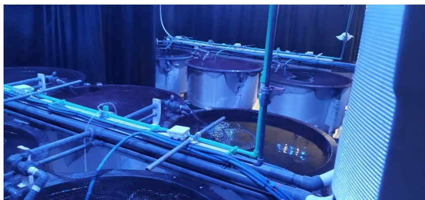
Εικόνα 3. Σύστημα οξυγόνωσης πειραματικών δεξαμενών 500lt
