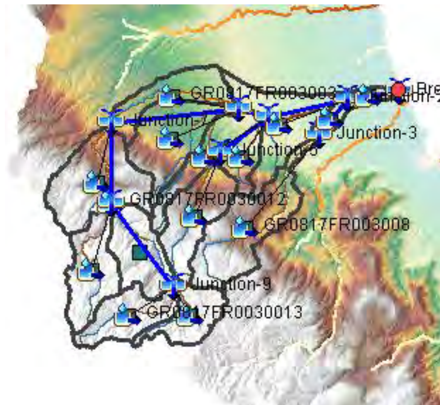
Σχήμα 5.2: Όρια υπολεκανών της λεκάνης απορροής στο περιβάλλον του HEC-HMS
