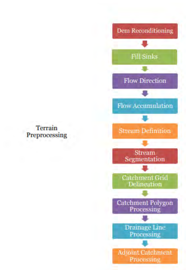
Σχήμα 3.7 : Βήματα για την προ-επεξεργασία του ψηφιακού μοντέλου εδάφους
