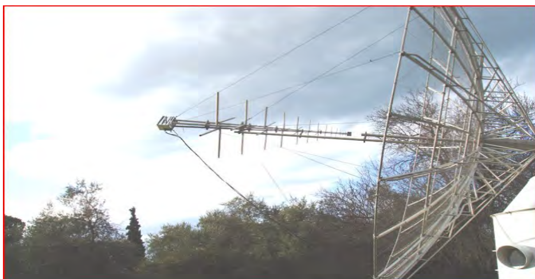
Εικόνα 1.8. Η κεραία παραβολικού κάτοπτρου καλύπτει τις συχνότητες 20-650MHz.Είναι ευδιάκριτα δε, η περιοδικη-λογαριθμικη, ο προενισχυτής και η καμπίνα.[2].
