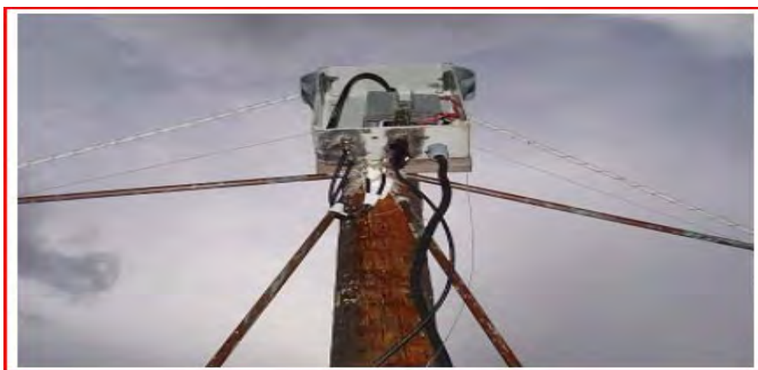
Εικόνα 1.10.α) Άποψη της ανεστραμμένης V διπολικής κεραίας , από το Βορρά. β) Εδώ εμφανίζεται το κουτί στη κορυφή της κεραίας και τα δυο βασικά καλώδια τροφοδοσίας (χοντρό και σήματος (λεπτό)).[2].
