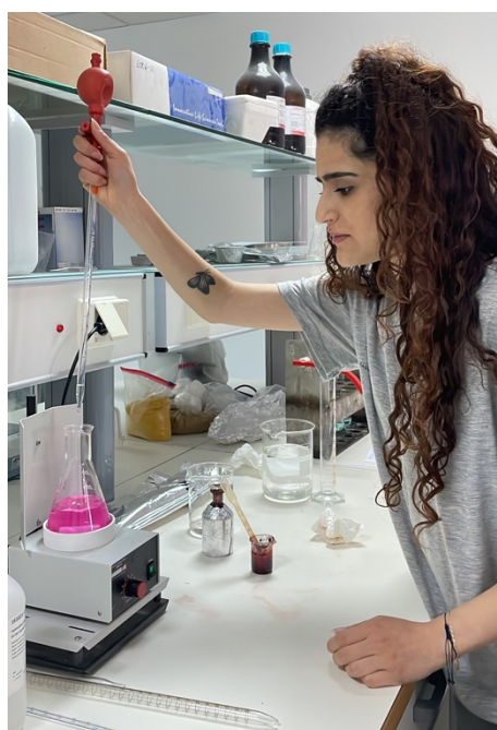
Εικόνα 18: αριστερά: Συσκευή απόσταξης (Steam Distillation Apparatus S4, Behr, Germany), δεξιά: Τίτλοδοτηση του διαλύματος βορικού αμμωνίου με αραιό διάλυμα υδροχλωρικού οξέος (0,1N) υπό καθεστώς συνεχούς κίνησης
