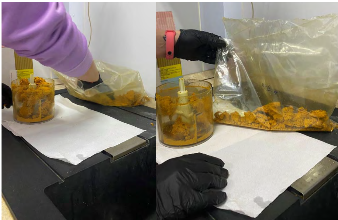
Εικόνα 41. Τοποθέτηση στον πολυκόφτη για θρυμματισμό
