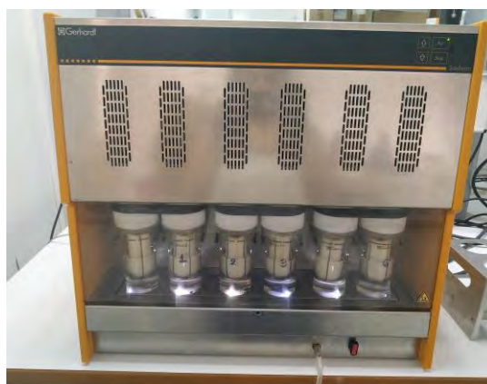
Εικόνα 2.3. Συσκευή εκχύλισης λίπους (Φωτογραφία συγγραφέα).
