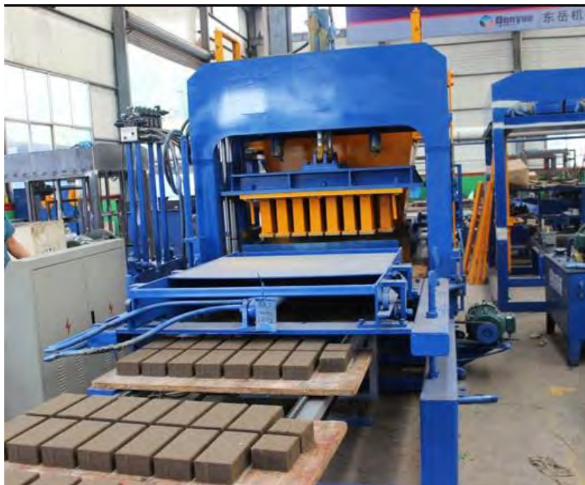
Εικόνα 89: Πρέσα πλίνθων σε γραμμή παραγωγής. (ΠΗΓΗ: https://aimixconcreteblockmachine.com/press-brick-machine/ )
