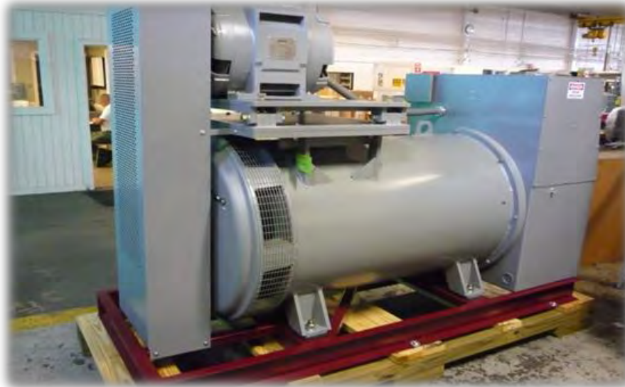
Εικόνα 48: Σύγχρονος συμπυκνωτής σε βιομηχανική εγκατάσταση. (ΠΗΓΗ: www.mepits.com )
