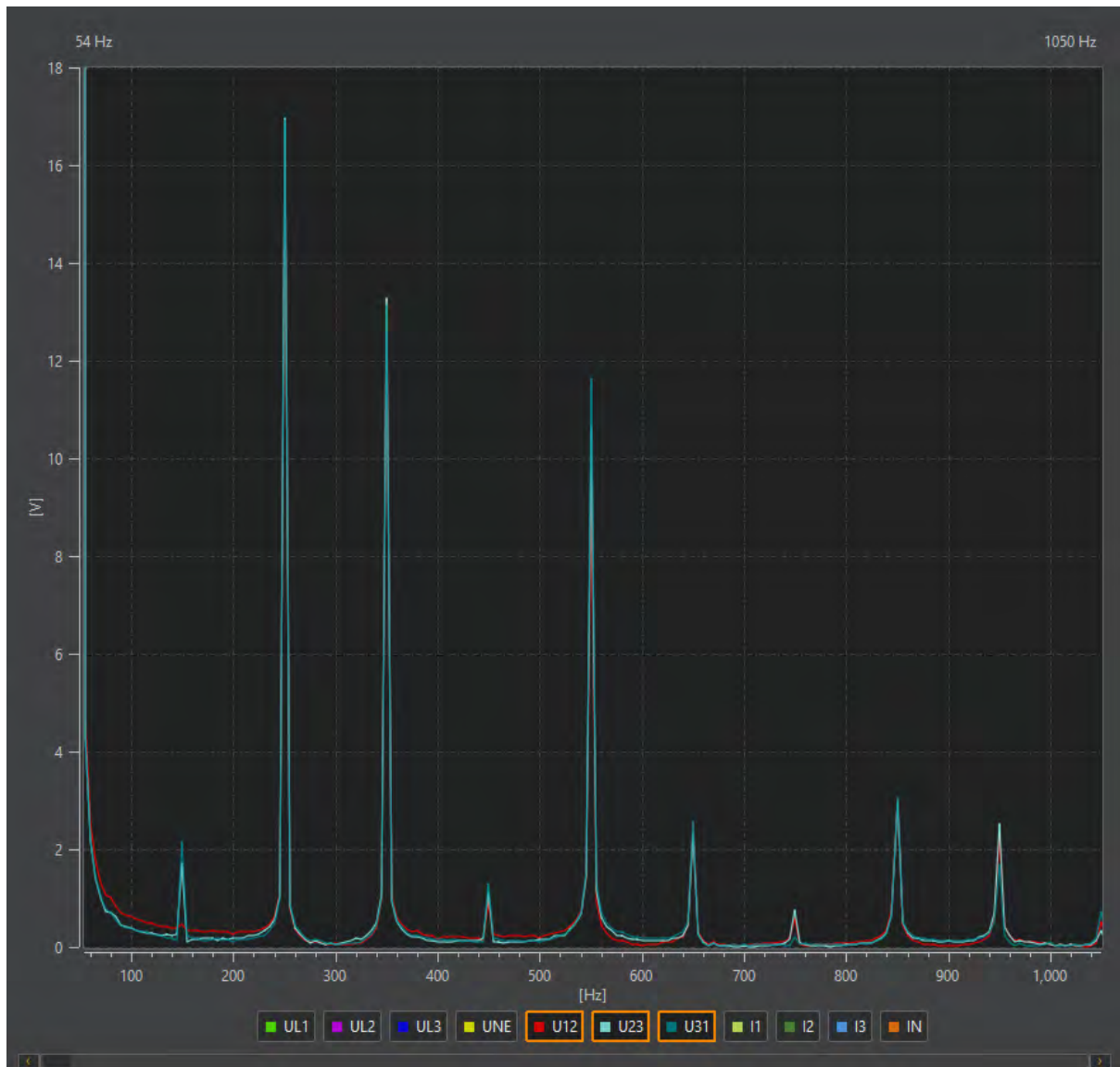
Εικόνα 95: Fast Fourier Transform τάσεων της στιγμιαίας κυματομορφής..
