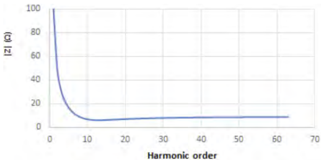
Εικόνα 76: Τυπική απόκριση συχνότητας εμπέδησης σε φίλτρο 2 ης τάξης high pass 11 ης . αρμονικής (ΠΗΓΗ: https://www.pscad.com )
