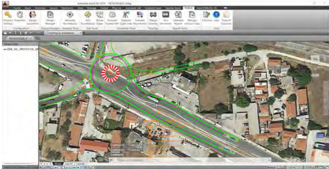
Εικόνα 32. Έλεγχος κίνησης οχήματος σχεδιασμού επί της περιφερειακής οδού Λαρίσης – Βόλου
