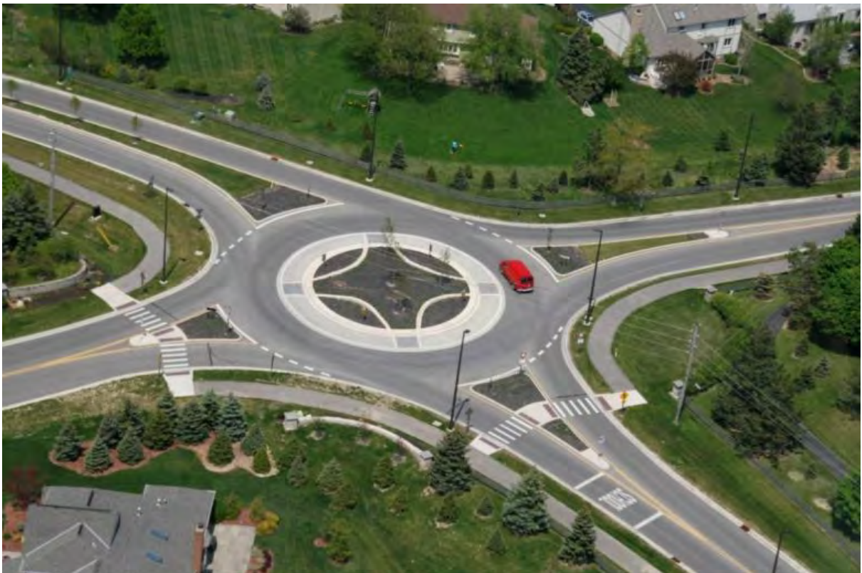
Εικόνα 9. Τυπικός κυκλικός κόμβος μιας λωρίδας (Brilon, 2011)
