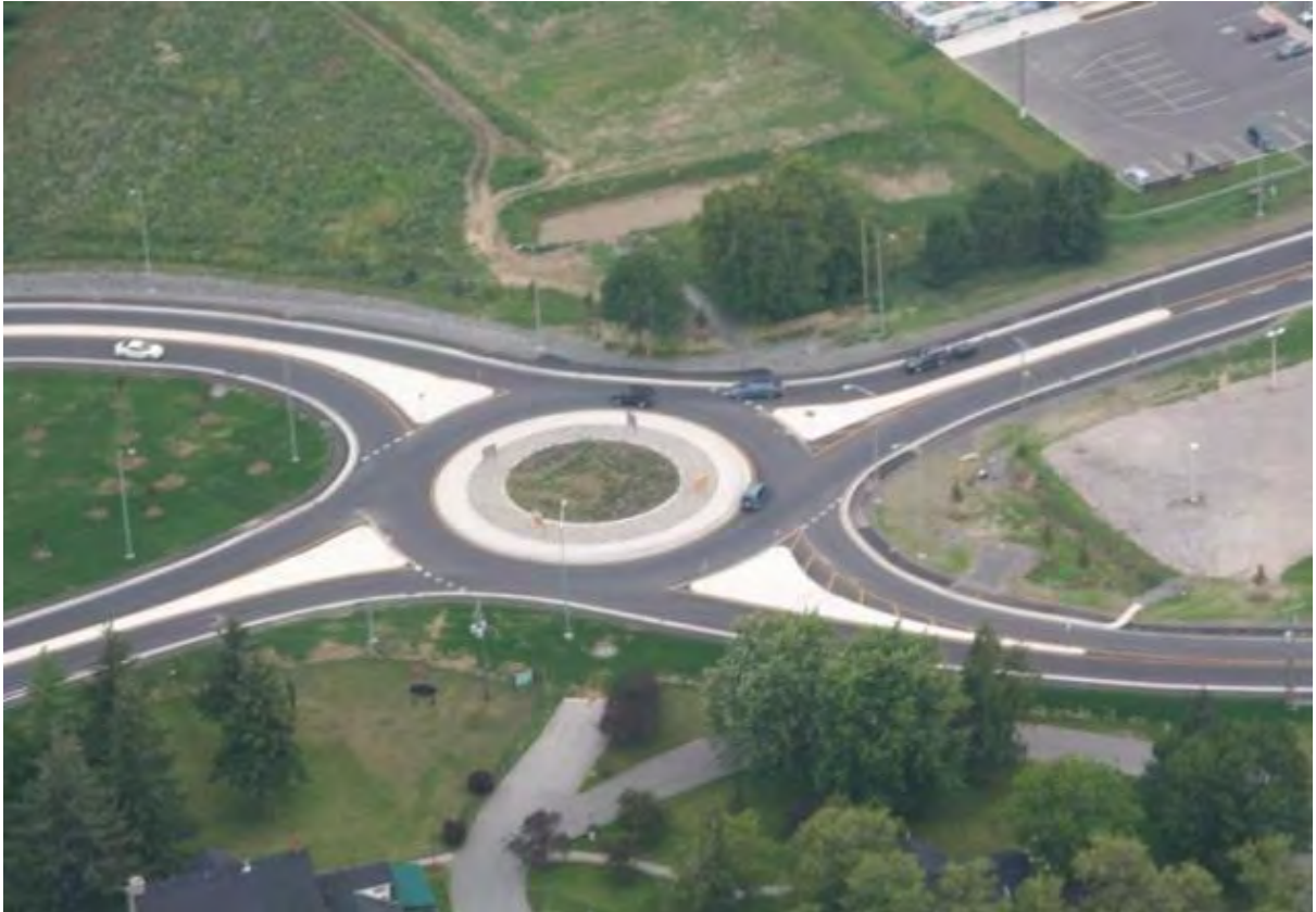
Εικόνα 13. Απλός Κυκλικός Κόμβος (μίας λωρίδας) (Brilon, 2011).
