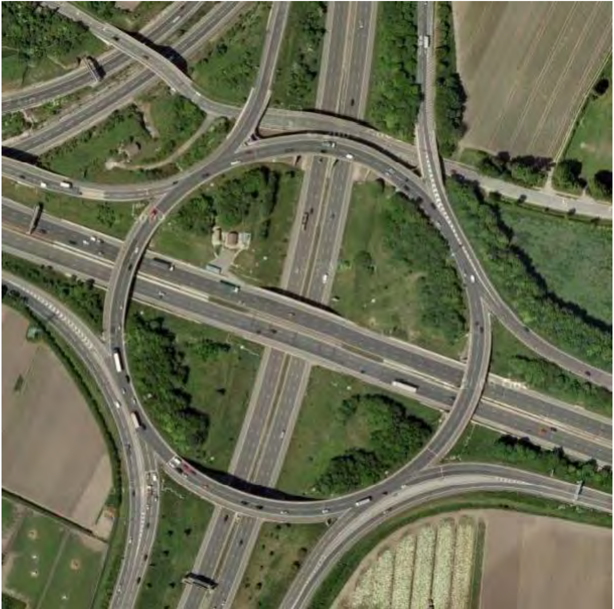
Εικόνα 11. Κυκλικός Κόμβος Τριών Επιπέδων ( The Highways Agency et al., 2007 ).
