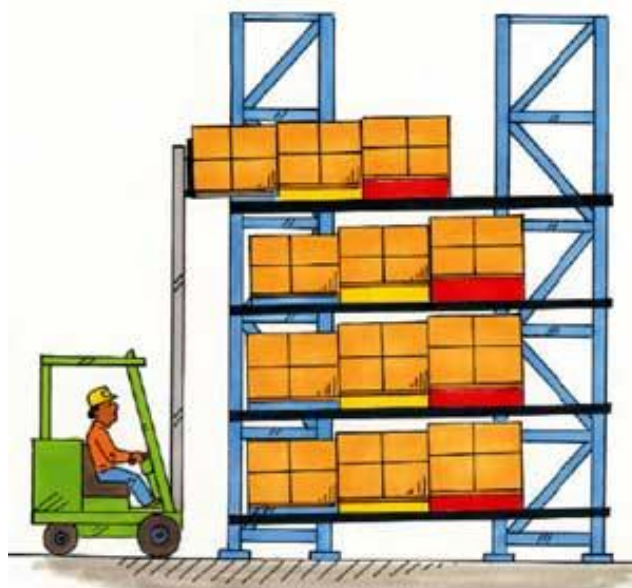
Εικόνα 2.8: Το σύστημα push-back χρησιμοποιεί τη βαρύτητα για την ανάκτηση παλετών
