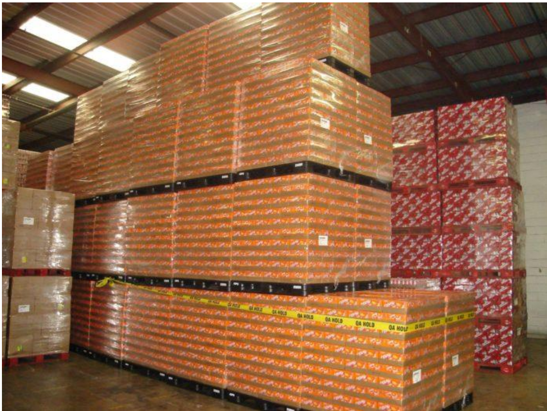
Εικόνα 2.2: Η στοίβαξη δαπέδου εξαλείφει την ανάγκη για ράφι παλετών
