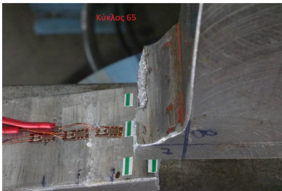
Εικόνα 22. Αστοχία του δοκιμίου A4 κατά τον 65 ο κύκλο
