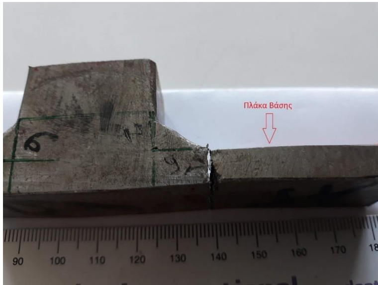
Εικόνα 25. Μακροδομή του δοκιμίου A5
