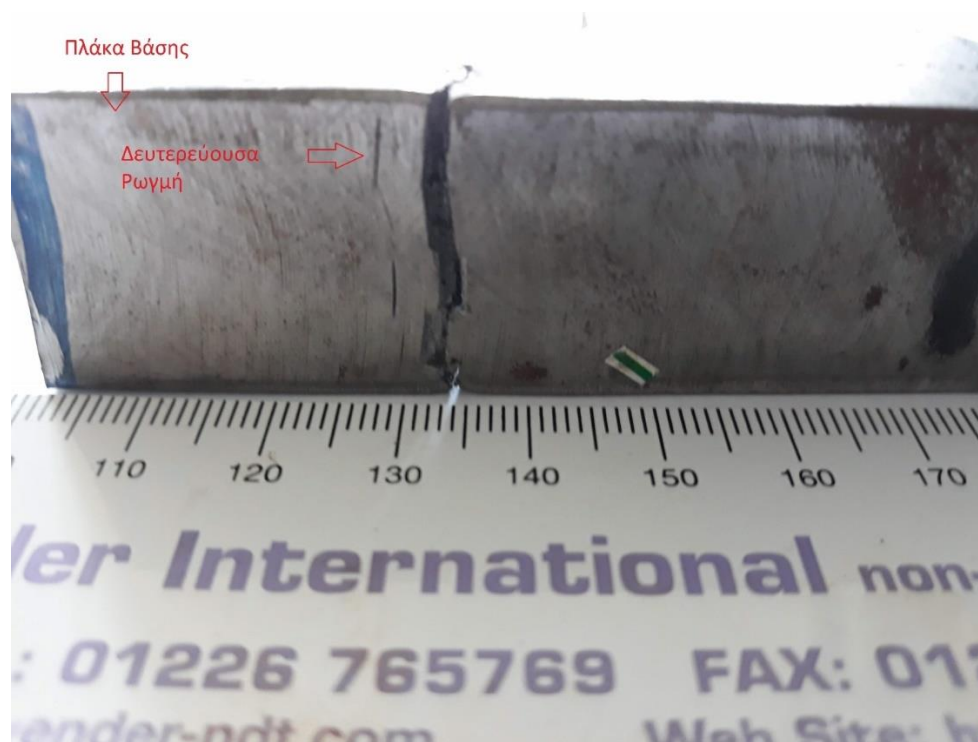
Εικόνα 14. Κάτω επιφάνεια του δοκιμίου A2 (Δευτερεύουσα ρωγμή παράλληλα στην επιφάνεια θραύσης)
