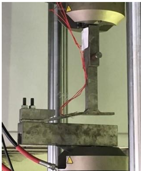
Εικόνα 4. Παραμορφωμένο δοκίμιο κατά την διάρκεια δοκιμής κόπωσης μετά από ανύψωση (Δυ) ίση με 35mm
