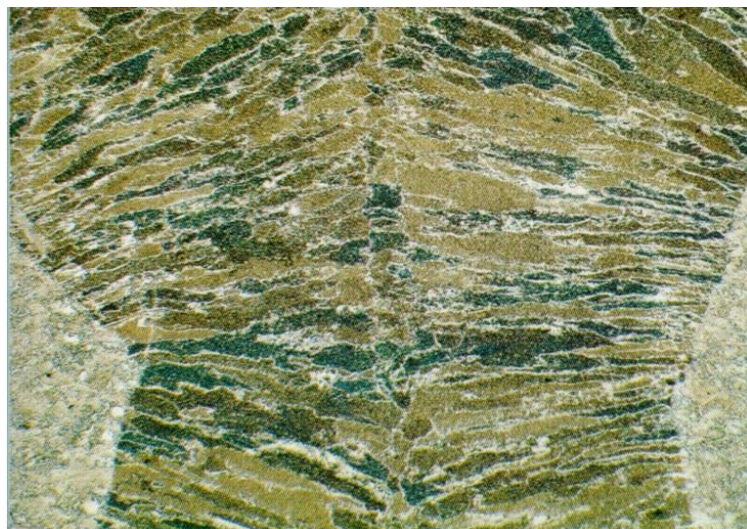
Εικόνα 1. Δενδριτική στερεοποίηση του μετάλλου συγκόλλησης κατά μήκος των γραμμών ροής της θερμότητας
