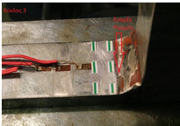
Εικόνα 9. Έναρξη της ρωγμής του δοκιμίου A2 κατά την διάρκεια του 3 ου κύκλου
