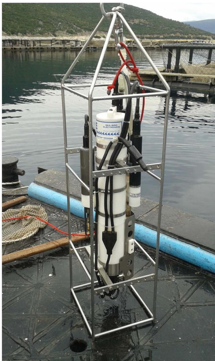
Εικόνα 2.3: Συνεχής καταγραφέας φυσικοχημικών και βιολογικών χαρακτηριστικών του νερού (SEABIRD-19plus).
