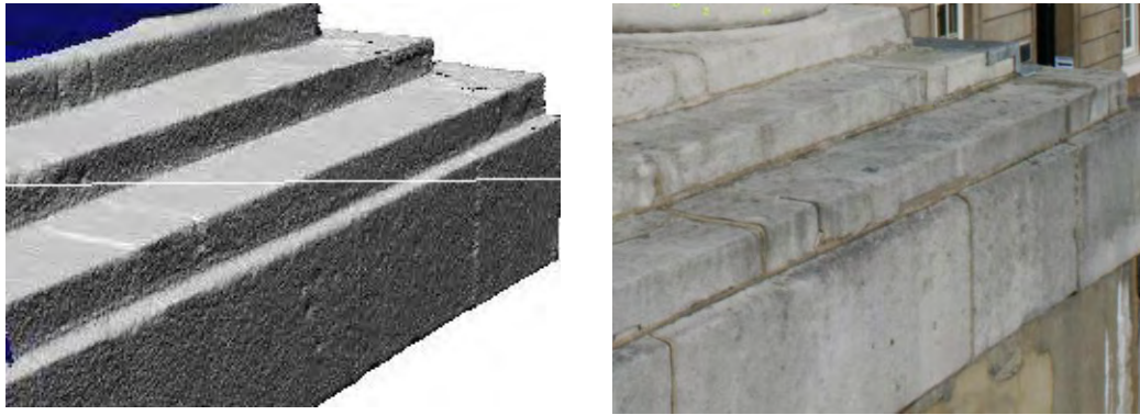
Εικόνα 3.7 Σύγκριση μεταξύ του τρισδιάστατου μοντέλου σάρωσης με laser (αριστερά) και της αντίστοιχης εικόνας στην πραγματικότητα (δεξιά) (Μωϋσιάδης 2004).
