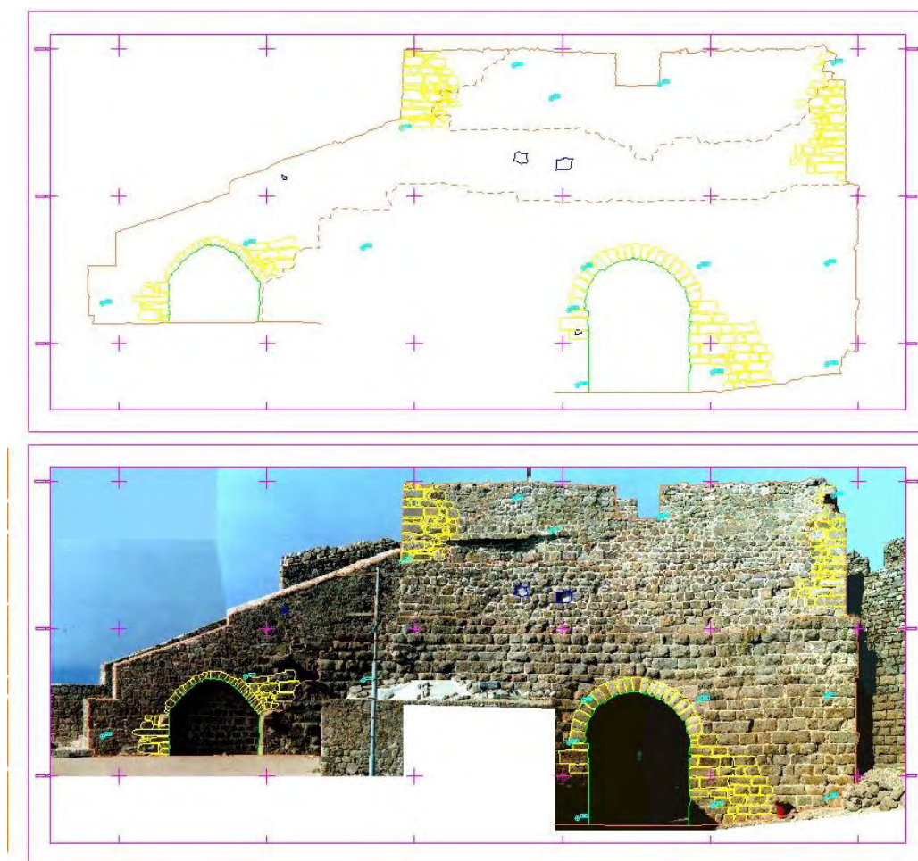
Εικόνα 3.5 Φωτογραμμετρική απόδοση της εσωτερικής όψης του μεταπυργίου και εισόδου του κάστρου της Μήθυμνας Λέσβου (Αστρολάβος 2012).
