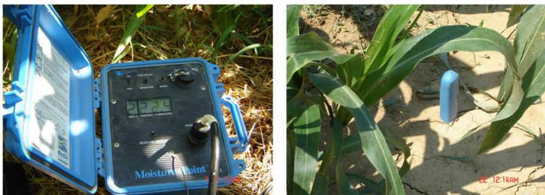
Φωτογραφία 6.2: Συσκευή T.D.R. και κεφαλή του αισθητήρα του οργάνου.
