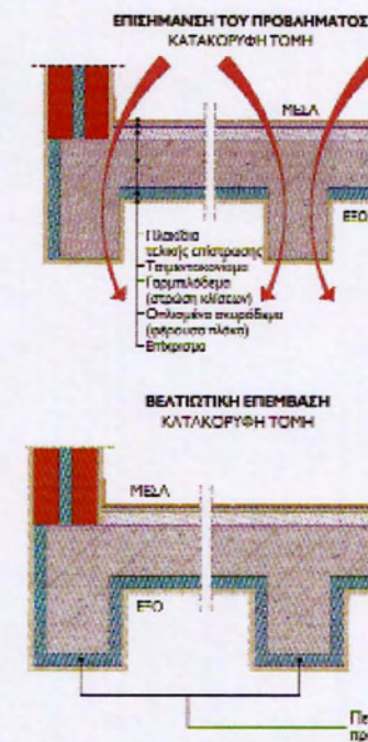
εικ.176 Απουσία θερμομόνωσης σε ενδιάμεσα και περιμετρικά δοκάρια στην οροφή υπογείου ή πιλοτής, και εικ. Επίλυση του προβλήματος με θερμομονωτική προστασία περιμετρικά των δοκαρίων και για λόγους προστασίας μπορεί να καλυφθεί με γυψοσανίδα (πηγή: Κτίριο, (νοέμβριος 2009, τεύχος 10, σελ.130)
