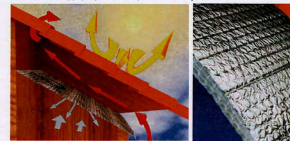
ΕΙΚ.25_ "Reflective insulation" και λειτουργία, (πηγή: http://www.polynum-insulation.com/ )
