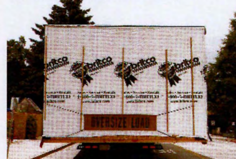
ΕΙΚ.183_τα μέρη της κατοικίας μεταφέρονται με φορτηγό στο τόπο εγκατάστασης, (πηγή: βιβλίο Prefab Green, των Michelle Kaufmann/ Catherine Remick, Σελ.68)
