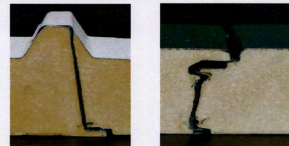
ΕΙΚ.303-305_Σύνδεση υλικών και τομή "σάντουιτς" μείωση μετάδοσης θερμότητας, (πηγή: άρθρο του Prof. Dr. -Ing.Markus Feldmann, RWTH, University of Technology Aachen)
