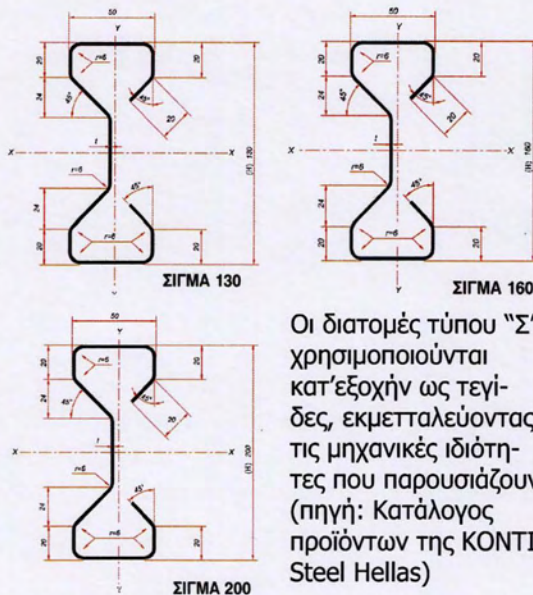
ΕΙΚ.292 Πίνακας με τα γεωμετρικά μεγέθη διατομών τύπου "Σ130, Σ160, Σ200", (πηγή: Κατάλογος προϊόντων της KONTI Steel Hellas)
