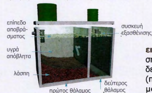
ΕΙΚ.355_λειτουργία σηπτικής δεξαμενής, (πηγή: http://genesbackhoseservice.com/index.php?p=1_5_Septic-System-FAQ )
