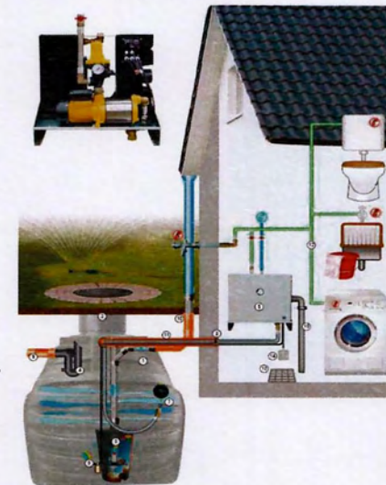
Συλλογή και οικιακή χρήση βρόχινου νερού με τη βοήθεια υπόγειας δεξαμενής (GreenLife GmbH)
