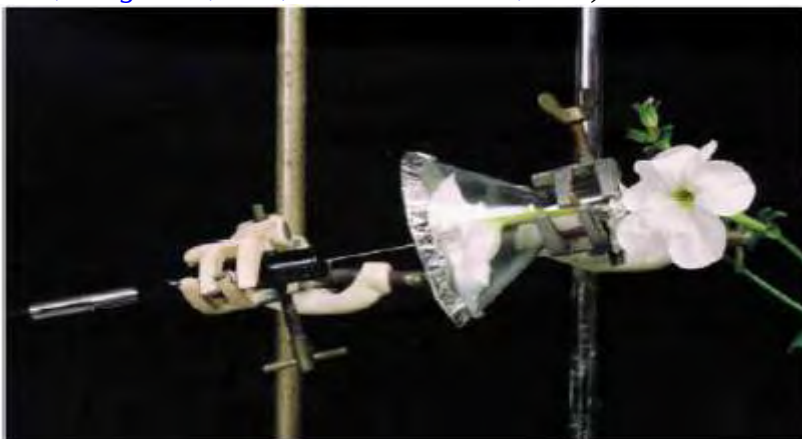
Σχήμα 13. SPME in vivo από λουλούδι για την απομόνωση αρωματικών ουσιών
