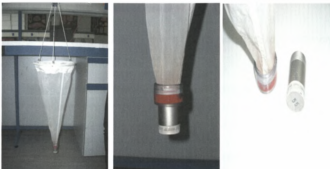
Εικόνα 8 : Κωνικό πλαγκτονικό δίχτυ με δοχείο συμπύκνωσης – συλλεκτήρα
