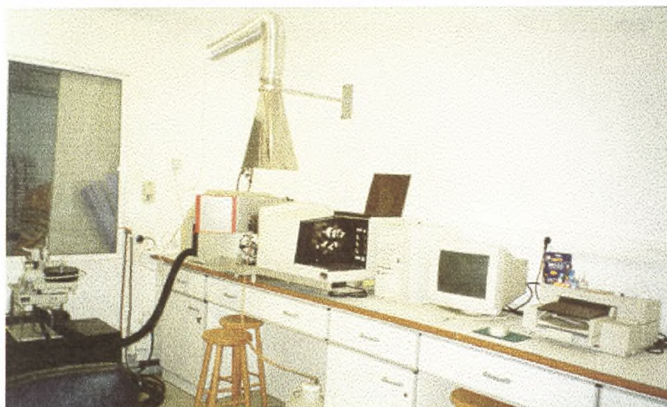
Εικόνα 5. Ατομική Απορρόφηση (Εργαστήριο Εδαφολογίας Πανεπιστημίου Θεσσαλίας)
