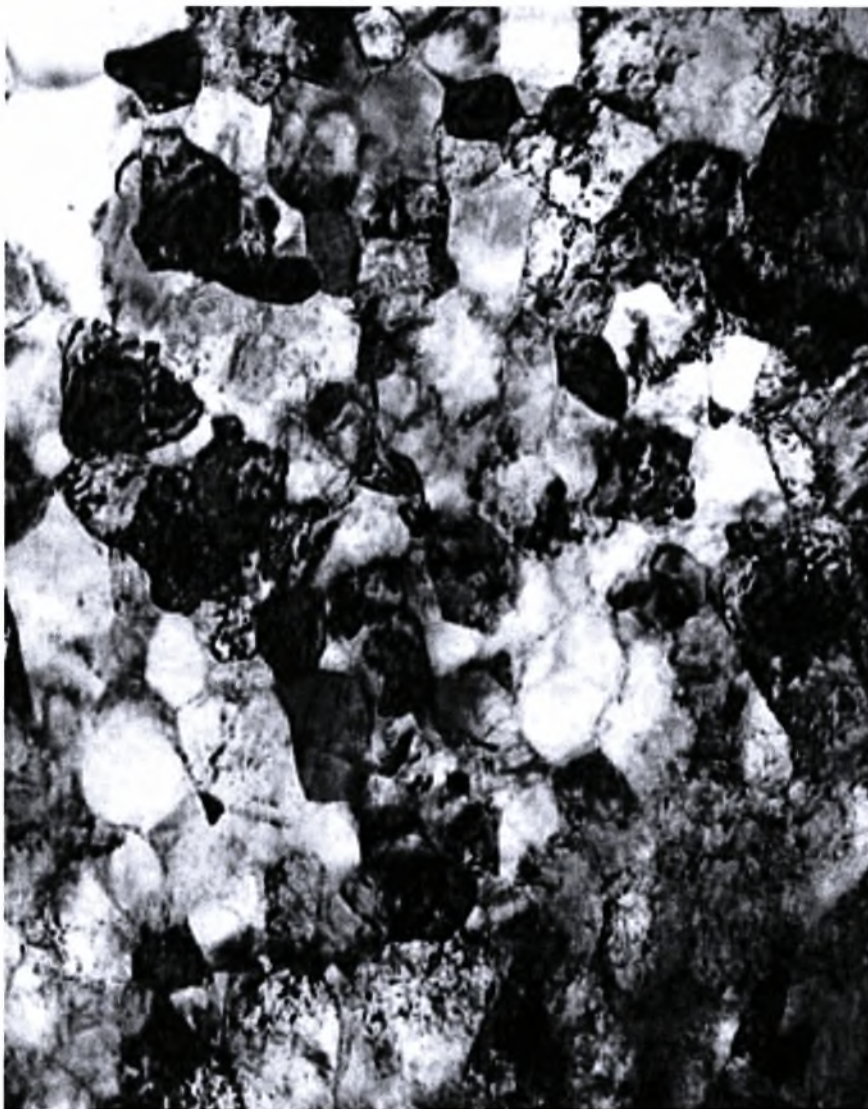
Σχήμα 2.2 Νανοκρυσταλλικός σιδήρου που παράγονται με ενοποίηση, το πλάτος του η φωτογραφία αντιπροσωπεύει 850 nm.
