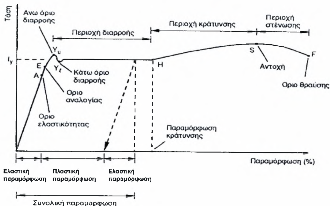
Γράφημα 11. Διάγραμμα τάσης παραμόρφωσης ενός τυπικού υλικού (Πηγή: Λίτινας και Γιαννακόπουλος, 1999).
