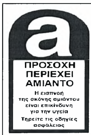
Σχήμα 22. Σήμανση υλικών, τα οποία περιέχουν αμιάντο (Πηγή: Δρίβας, 2005α).
