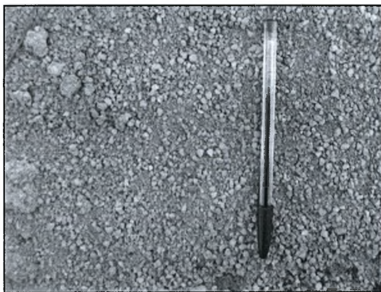
Εικόνα 5. Άμμος λατομείου (το στυλό στη φωτογραφία αποτελεί συγκριτικό δείκτη κλίμακας) (Πηγή: προσωπικό αρχείο Δ. Τσιώτα).
