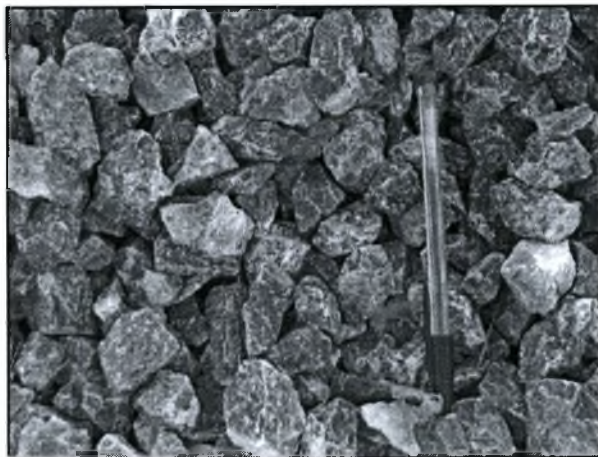
Εικόνα 8. Χαλίκι λατομείου. Το στυλό αποτελεί σχετική ένδειξη κλίμακας (Πηγή: προσωπικό αρχείο Δημήτρη Τσιώτα).
