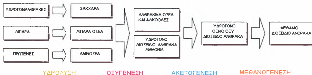
Σχήμα 2-3: Σχηματική απεικόνιση των σταδίων που λαμβάνουν χώρα κατά την αναερόβια επεξεργασία
