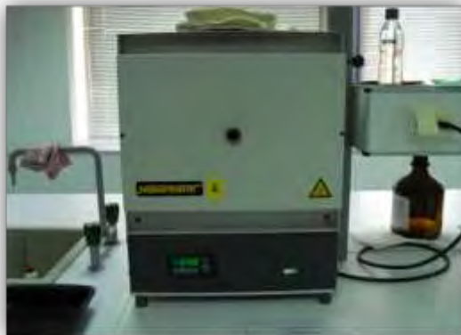
Εικόνα 18: Αποτεφρωτήρας (Nabertherm, φωτογραφία συγγραφέα).
