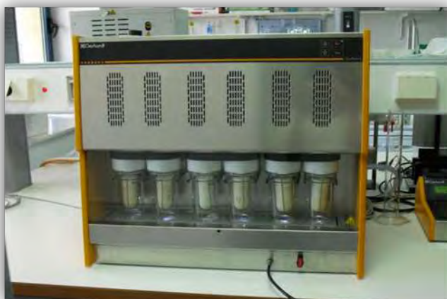
Εικόνα 17: Συσκευή εκχύλισης (Soxtherm της Gerhardt, φωτογραφία συγγραφέα).
