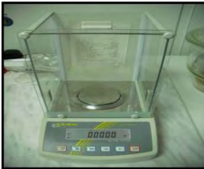
Εικόνα 12: Ζυγός ακρίβειας 4 δεκαδικών ψηφίων (Kern ALS 220-4, φωτογραφία συγγραφέα)
